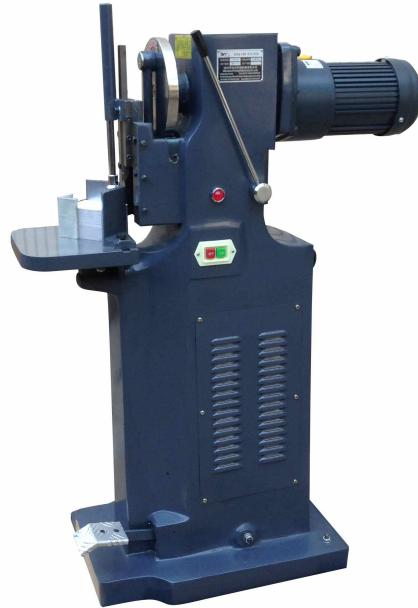
工作时，先根据待切工件的大小，通过左右横向螺杆5、横向定位滑块12调好两个燕尾导向座11的距离，将工件放到工作台4上，并使后边沿靠到纵向定位块9的前面，再由横向定位滑块12将工件的横向锁定。
